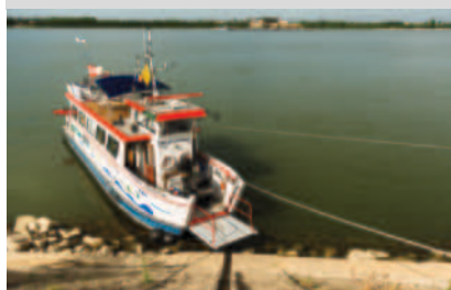
Zum Laden oder An-Land-Bringen hat sich die Bugklappe bestens bewährt
