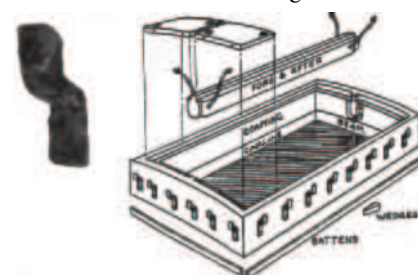
Abb. 11 Links: einfache Klampe vom Lukensüll des Hauptladeraums der W.J.C. (Länge 19 cm); Rechts: Süll und Sicherungselemente einer Luke (nach Bennet)
