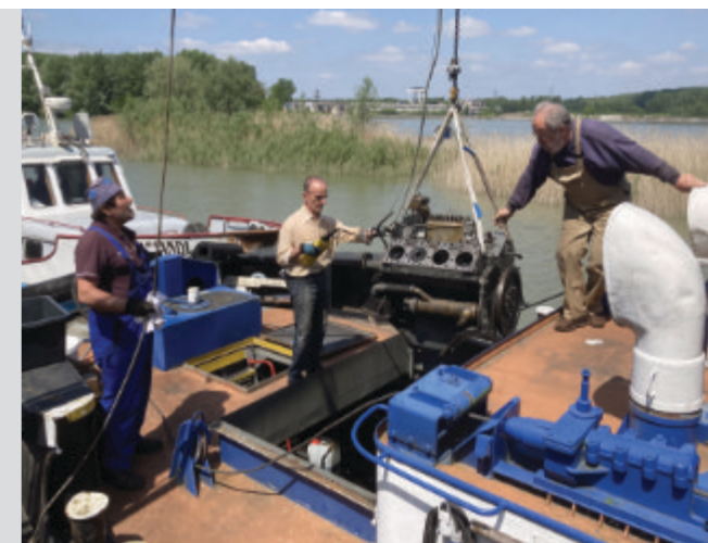
Bild 4: Nach vielen Arbeitsstunden des Mechaniker-Teams wurde die zum Einbau vorbereitete Maschine aus dem Laderaum 4 zum GNOM gehoben. (Bild: Stephan Kleibel).
