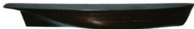
Bild 1: Das Halbmodell, nach dem die W.J.C. gebaut wurde. Die Stärke der verwendeten Bretter betrug von oben 3,2 cm bis unten 1,8 cm (Länge des Modells: 103,3 cm, Höhe: 12,3 cm).
