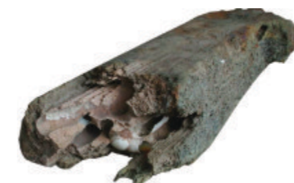
Bild 6: Von »Schiffsbohrwürmern« (teredo navalis) zerfressenes Holzstück von W.J.C. Obwohl diese Organismen landläufig als »Würmer« bezeichnet werden, sind sie tatsächlich Weichtiere (Mollusken). Daher rührt auch die muschelförmige Höhle, in der das Tier wohnt (Fundstück mit 57 x 11 cm).
