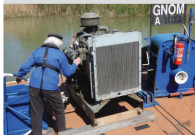
Bild 3: Der ehemalige Einsatzzweck als Generator-Antrieb ist am großen Luftkühler deutlich erkennbar. (Bild: Red.)
