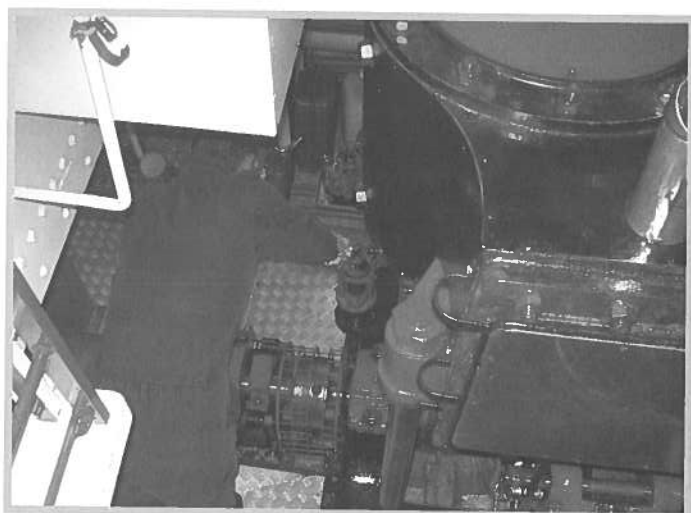
Der Maschinist bei der Arbeit, die Dampfmaschine und die Wellenlagerung werden laufend geschmiert
