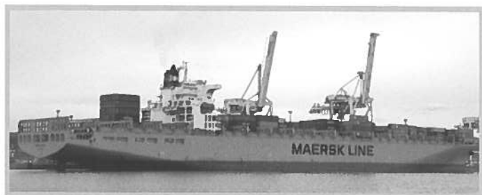
Containerschiff MAERSK KARACHI in Koper am 23. Juni 2009 (Foto: Luka Koper). Dieses Schiff wurde 1998 gebaut, ist 300 m lang und 43 m breit und kann eine Containerkapazität von 6.690 TEU aufnehmen. 1.600 Container hat das Schiff am 23. Juni in Koper auf- und abgeladen
