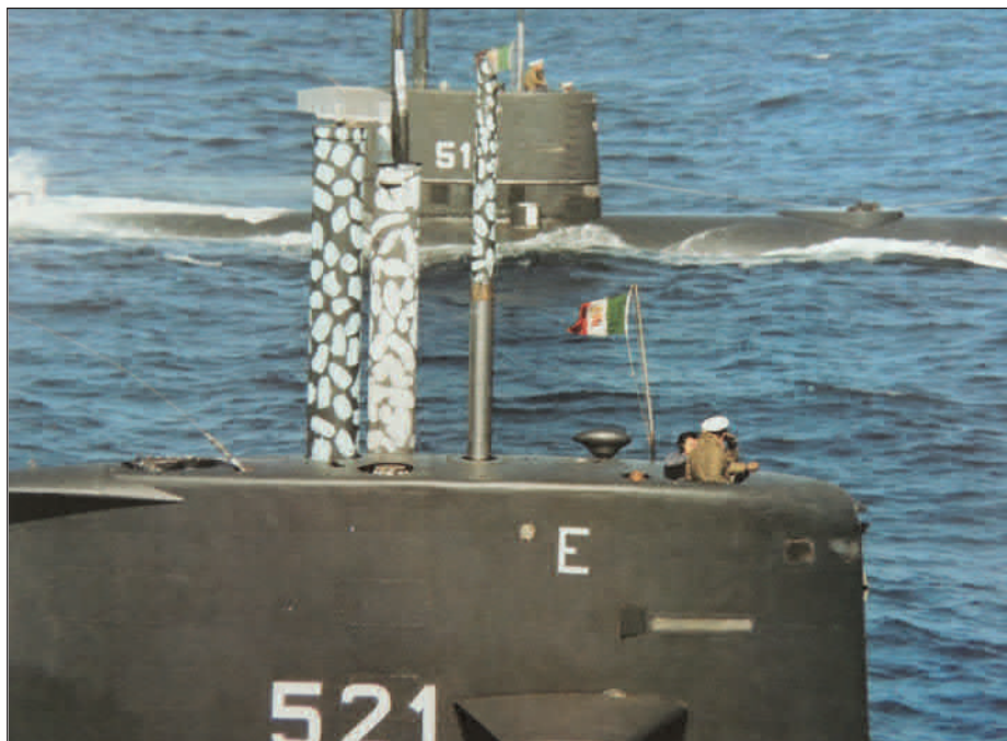
Abb.17: Die stromlinienförmigen Ausfabreinrichtungen für Radar/Optoelektronik/Schnorchel des italienischen Unterseebootes GUGLIELMO MARCONI in den 1990ern. Im Hintergrund das Unterseeboot ENRICO DANDOLO (Italienische Marine)
