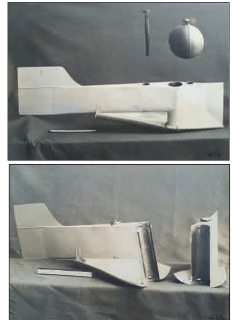
Abb. 11: Letztversion des Schwimmers von Gergacsevics
