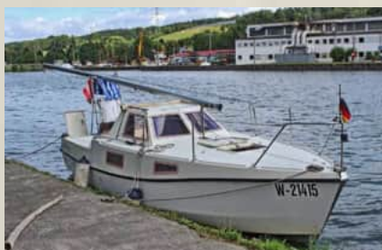
Mit umgelegtem Mast, ungehindert unter niedrigen Brücken hindurch
