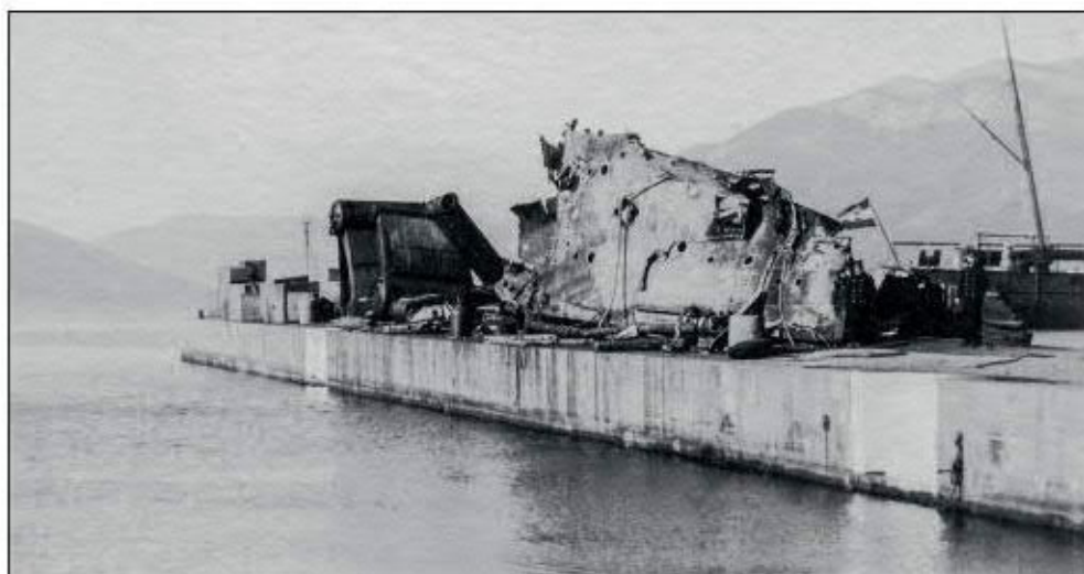
Abb. links: Vom gesunkenen Torpedofahrzeug HUSZAR geborgene Teile am Molo (wahrscheinlich in Teodo) in der Bocche di Cattaro. Vorne das Achterschiff, dahinter Kessel.
